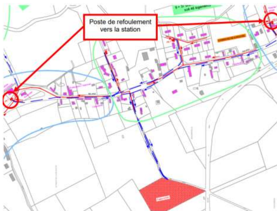
Localisation de la conduite de transfert des effluents
