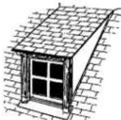
lucarne rampante ou en chien couché
